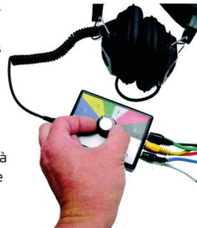
Si le bruit de craquement est perceptible lors de l'essai sur route dans dans une certaine position de l'interrupteur, notez la position du commutateur. Le L'essai peut être terminé.
