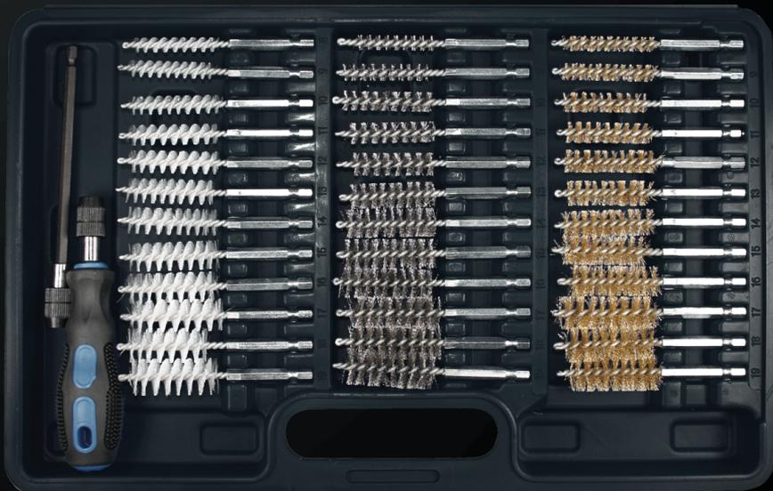
Bestehend aus einem Handgriff mit Verlängerung und 36 sortierten Bürsten mit 6,3 mm (1/4") Antrieb und 8-9-10-11-12-13-14-15-16-17-18-19 mm Durchmesser zum Reinigen und Entgraten von Zylindern, Buchsen, Rohren und anderen Werkstücken mit Nylon-, Messing- und Stahlbesatz.
