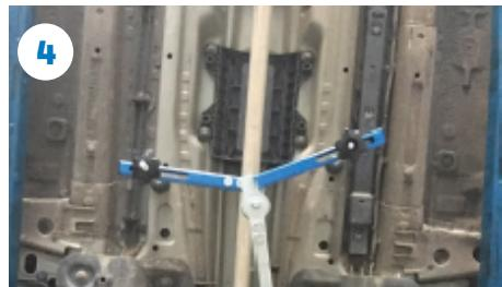
se aloja la base regulable de soporte del motor. Dispositivo dotado de dos brazos laterales orientables, en los que se alojan dos pies de apoyo que garantizan la estabilidad, afirmándose debajo del suelo ondulado del vehículo. Dispositivo dotado de dos ganchos que permiten una fijación segura al bastidor del vehículo.
