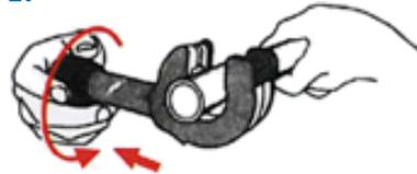
Griff im Uhrzeigersinn drehen bis das Schneidmesser am Rohr anliegt. ACHTUNG: Nicht zu fest anziehen!
