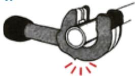
Legen Sie das Rohr in den Rohrschneider ein.
