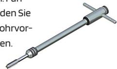
5. Wählen Sie nun das konische Zugwerkzeug (12) und den Zugbolzen (10). Drehen Sie den Zugbolzen in die Zugspindel und nutzen Sie einen 8 mm Ringschlüssel um den Zugbolzen festzuziehen. Drehen Sie den Zugbolzen mit Hilfe der Zugspindel in die Glühkerzenöffnung ein und drehen Sie mit Hilfe der Mutter SW30 den Rest der Glühkerze heraus. Nun kann eine neue Glühkerze eingesetzt werden.
